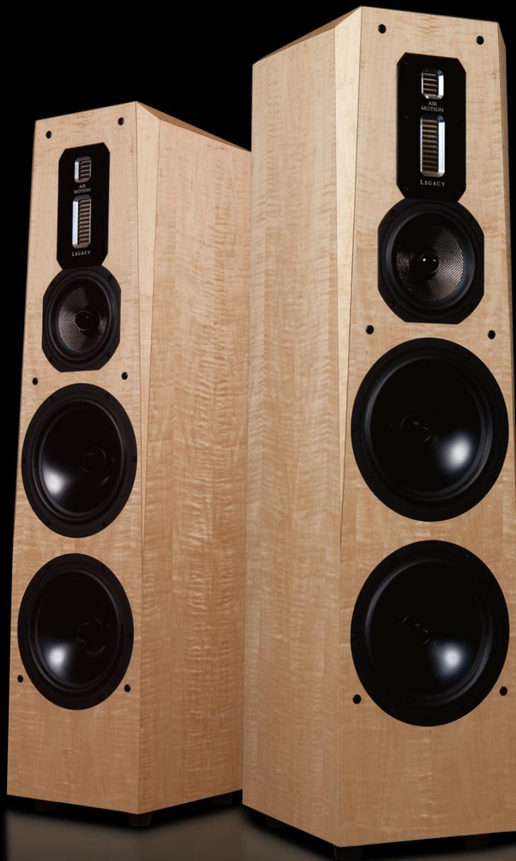
1980년대부터 리본형 유닛을 사용한 스피커 시스템을 발표해온 레거시 오디오는 2006년에 독자적인 리본형 유닛을 개발하게 되었다. 이것은 오스카 하일 박사의 특허인 주름진 진동판을 사용한 유닛으로 독일의 엘락을 비롯한 많은 회사에서 채택하고 있는 정평 있는 유닛이다. 레거시 오디오에서는 이 유닛을 개발하면서 더 강력한 네오디뮴 자석을 사용하였고, 진동판의 움직임의 범위를 확대하면서 왜곡을 최소화하기 위하여 좁고 긴 형태의 모습으로 발전시켰다. 이 결과 기존의 유닛보다 재생주파수 대역폭은 낮은 대역까지 확대시킬 수 있었고, 왜곡의 저감과 능률의 향상을 가져올 수 있었다.
